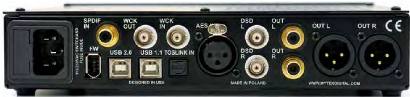
Die Black Mastering Version des Stereo192-DSD-DAC unterstützt alle relevanten Digital-Formate und hat zudem professionelle DSD-Eingänge.
